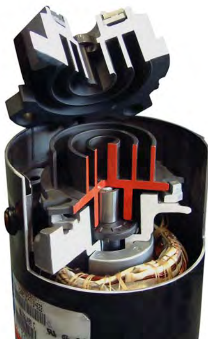
Модель спирального компрессора в разрезе (спиральный уплотнитель)
